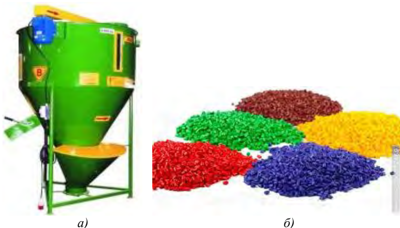
Рисунок 1 – Лабораторний малогабаритний змішувач кормосуміші конструкції вертикальної комбікормової установки ВМКУ-04 на 50 кг – а) та б) – барвники для мікротрейсерів п’яти кольорів: червоний, зелений, жовтий, васильковий та голубий
